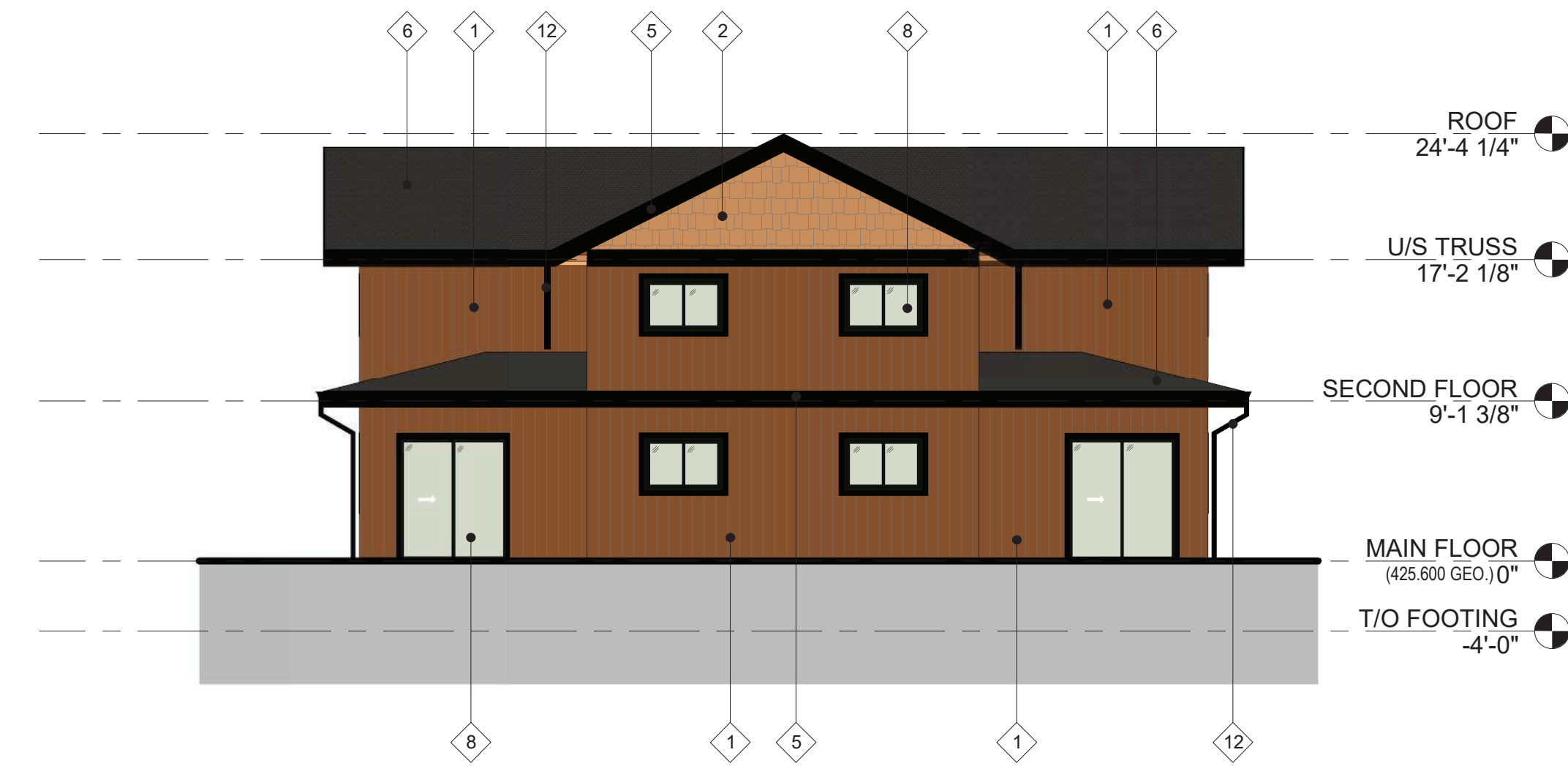
4 NORTH ELEVATION SCALE: 1/8" = 1'-0"
