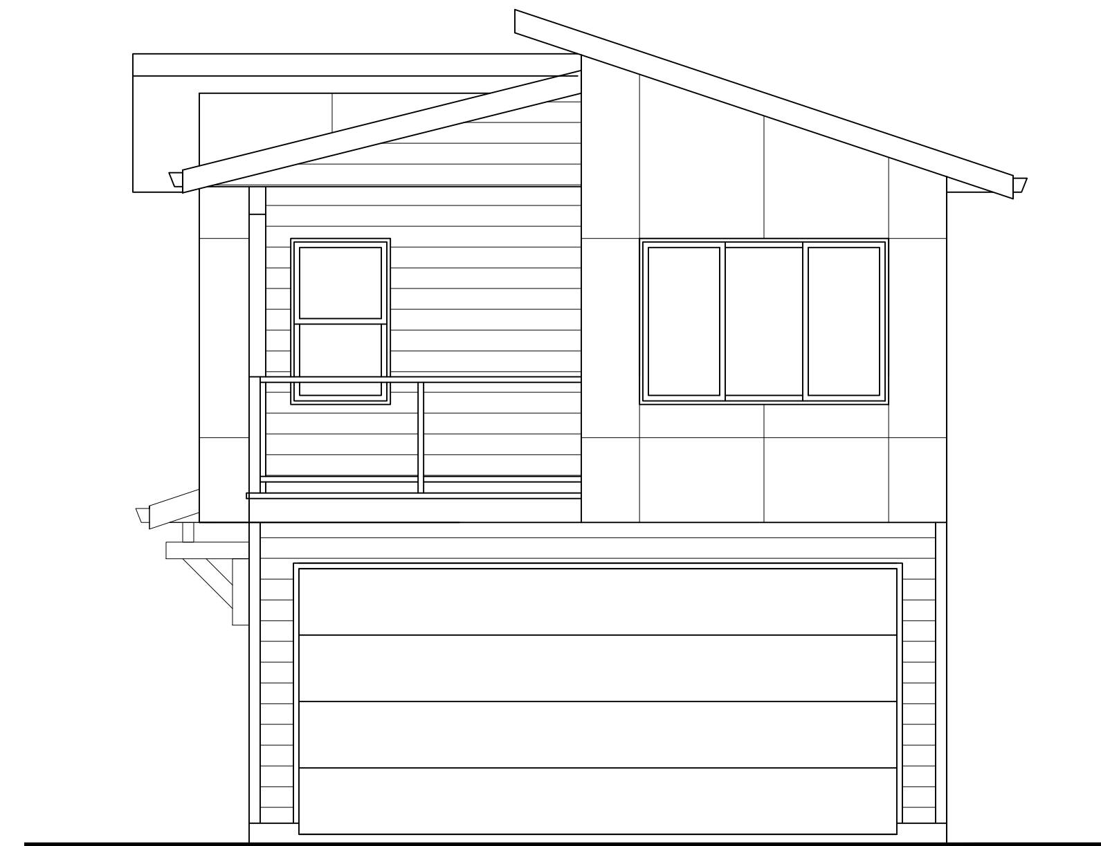
CARRIAGE HOUSE FRONT (LANE) ELEVATION
